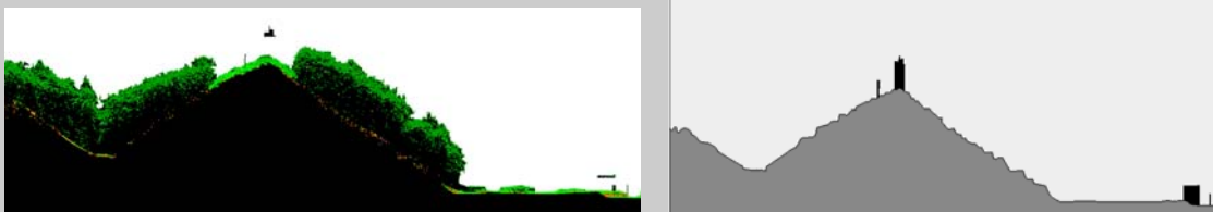
Obr. 10 Interpretované mračno bodů v podobě krajinného profilu (vlevo) a z něj vektorizací odvozený terénní profil s vyznačenými umělými objekty nad povrchem (vpravo). Za pozornost stojí dobře dokumentovaný mikoreliéf pod stromovými porosty (zčásti pravděpodobně zarostlé agrární terasy)
