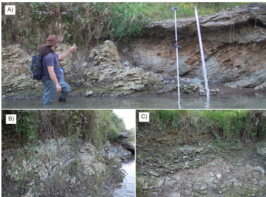
Obr. 55 Výskyt zlomových porúch neďaleko obce Breznica (A) v koryte vodného toku v pieskovcoch (B), na ktorých sú bazálne uložené štrky (C). (Farebný obrázok dostupný online).
